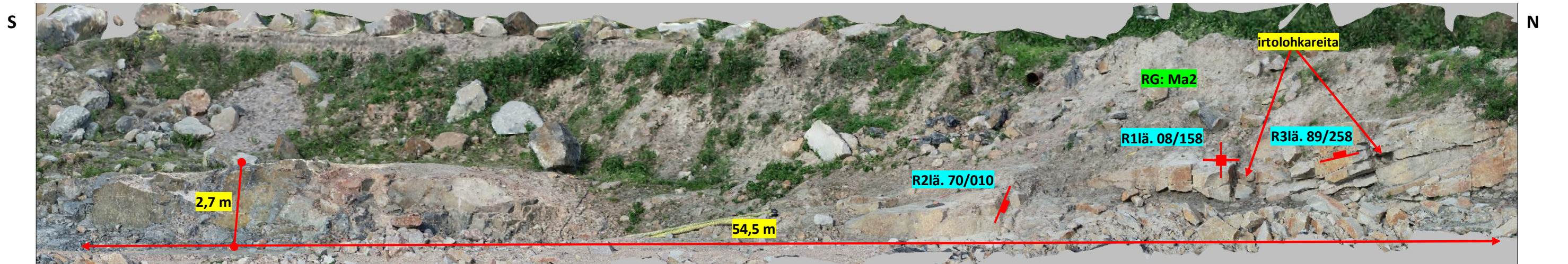
Liite 2.5a: Länsi-seinän analyysi ja havainnointi. Seinän kaade ja kaadesuunta ovat noin 80/110° ja sen korkeus on keskimäärin 5 m. RQD = 90 %.
